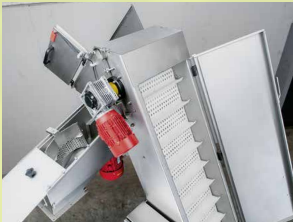
Die Abbildung zeigt den SA400-RM40 mit geöffneten Türen und ausgeschwenkter Rätzmühle
