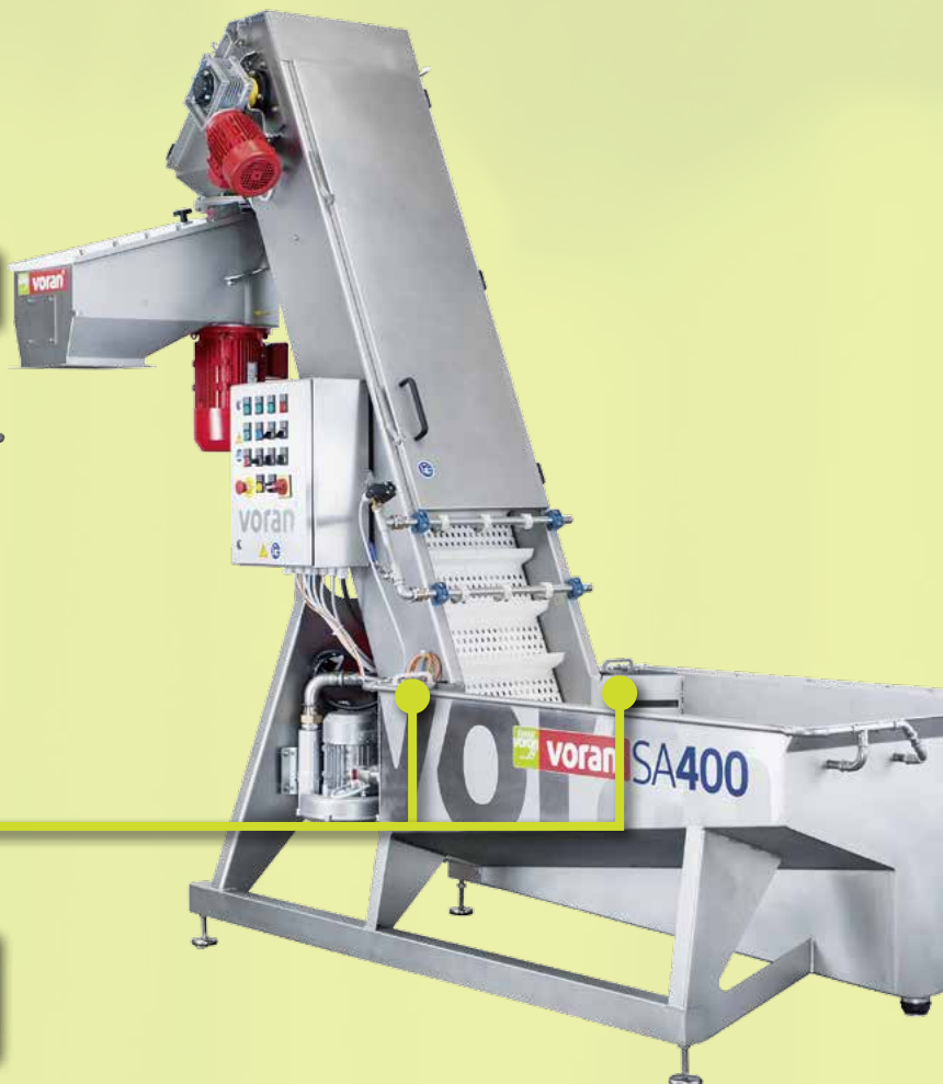
Die Abbildung zeigt den SA400-RM40 mit geöffneten Türen und ausgeschwenkter Rätzmühle
