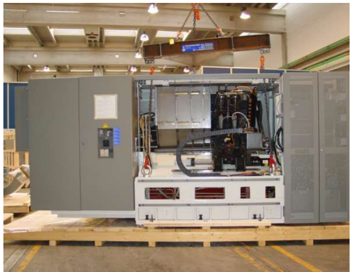
Abb. 10-2: Anheben des Hauptgehäuses der Maschine
