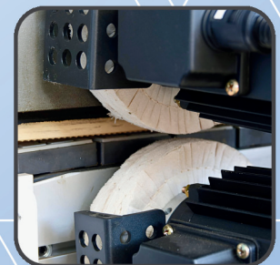
Schwabbelaggregat mit Reinigungsprüh-einrichtung
