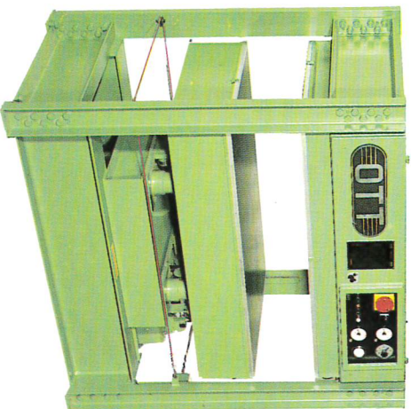
Zerlegbare Ausföhrung, wenn die Türöffnungen zu klein sind oder es sonstige Aufstellungsprobleme gibt.
