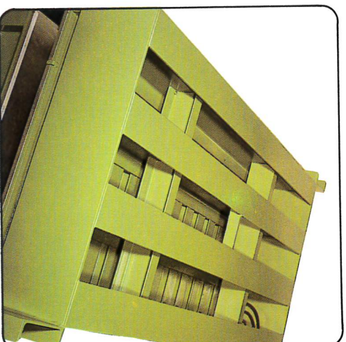
Abbildung zeigt stabiles Oberteil mit 4 starken Längsträgern
