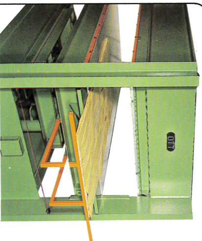
Abbildung zeigt ausziehbare Auflage an der linken (rechten) Stirnseite, für schonendes Aufliegen von überstehendem Preßgut.
