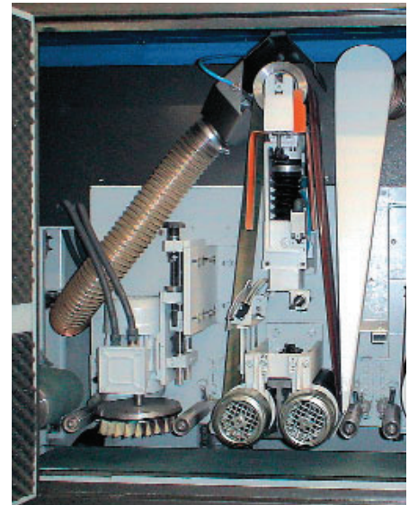
Je Seite 1 Schleifband + Disc. Ideal zum Schleifen von Klappladen-Lamellen
