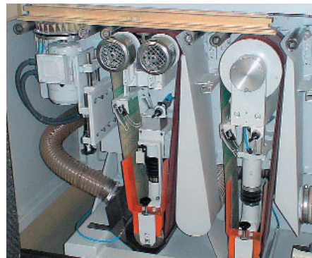
Je Seite 2 Schleifbänder + Disc. Top-Finish für Fensterteile
